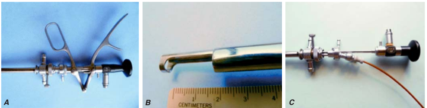
Figura 1. Partes esenciales del litotritor de Mauermayer: Camisa 23.5 Fr., elemento de trabajo con ventana distal y puente con canal para instrumentos.
